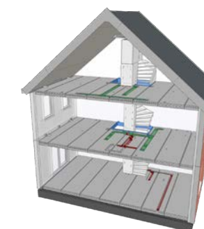
Doorsnede van een woning met prefab vloeren
